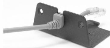
3. Вставить 8-контактный коннектор кабеля питания в разъем «Host» позади сканера до щелчка.
