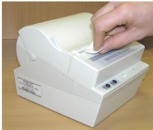
Рисунок 11- Видалення надлишку чекової стрічки
