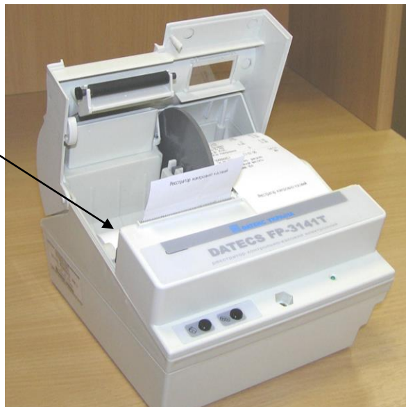
Рисунок 9 - Встановлення чекової стрічки
