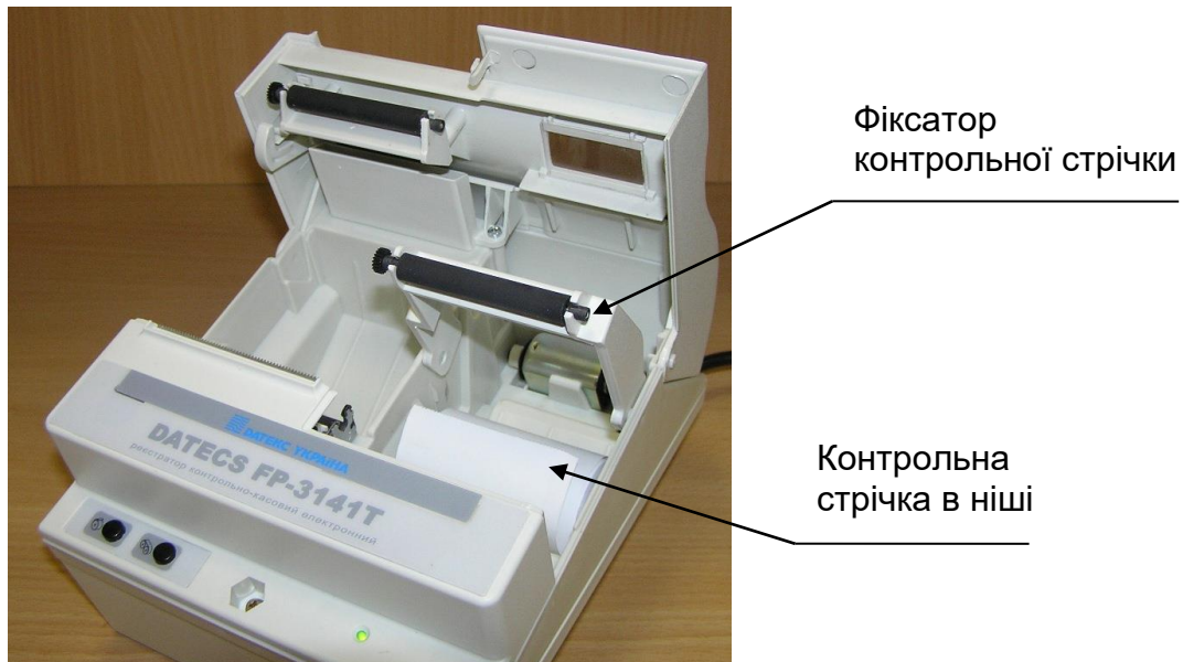
Рисунок 6 - Реєстратор з піднятим фіксатором контрольної стрічки
