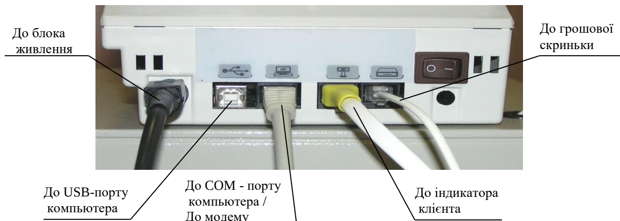
Рисунок 2 – Панель реєстратора для підключення кабелів
