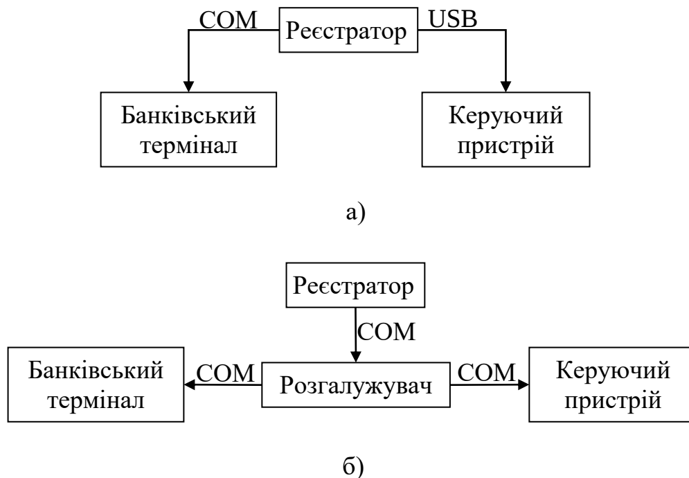
Рисунок 36 – Схема підключення банківського терміналу та керуючого пристрою до реєстратора
