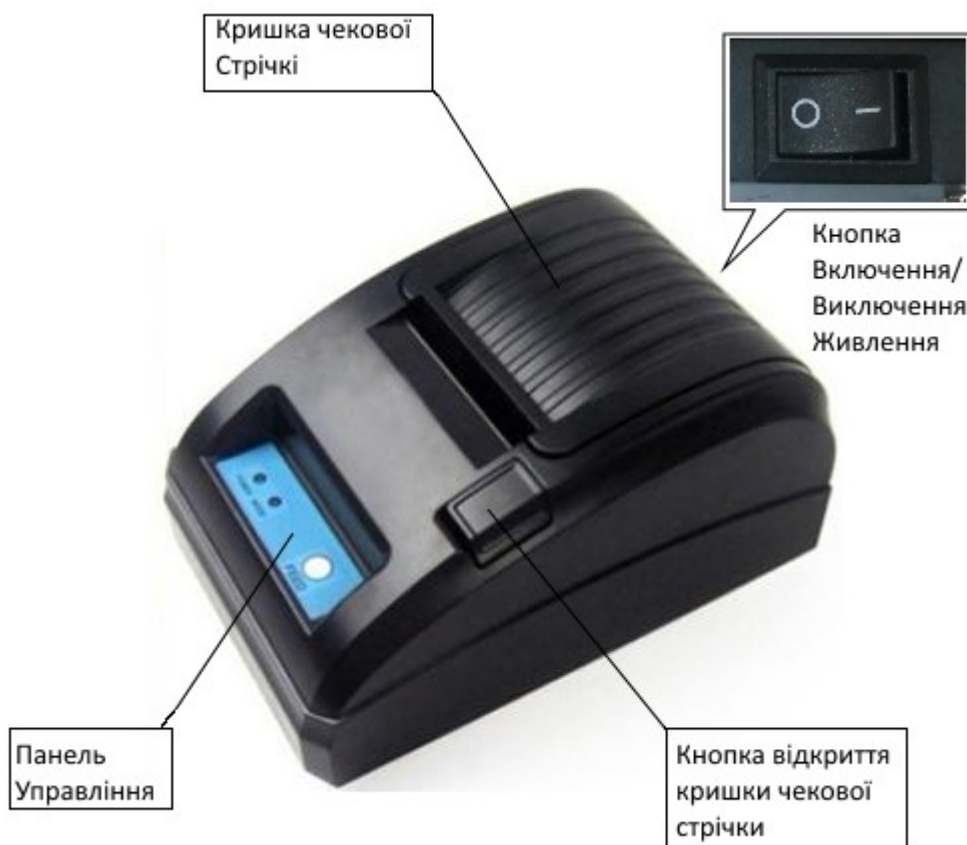
Рисунок 2 – Основні складові частини корпусу реєстратора.
