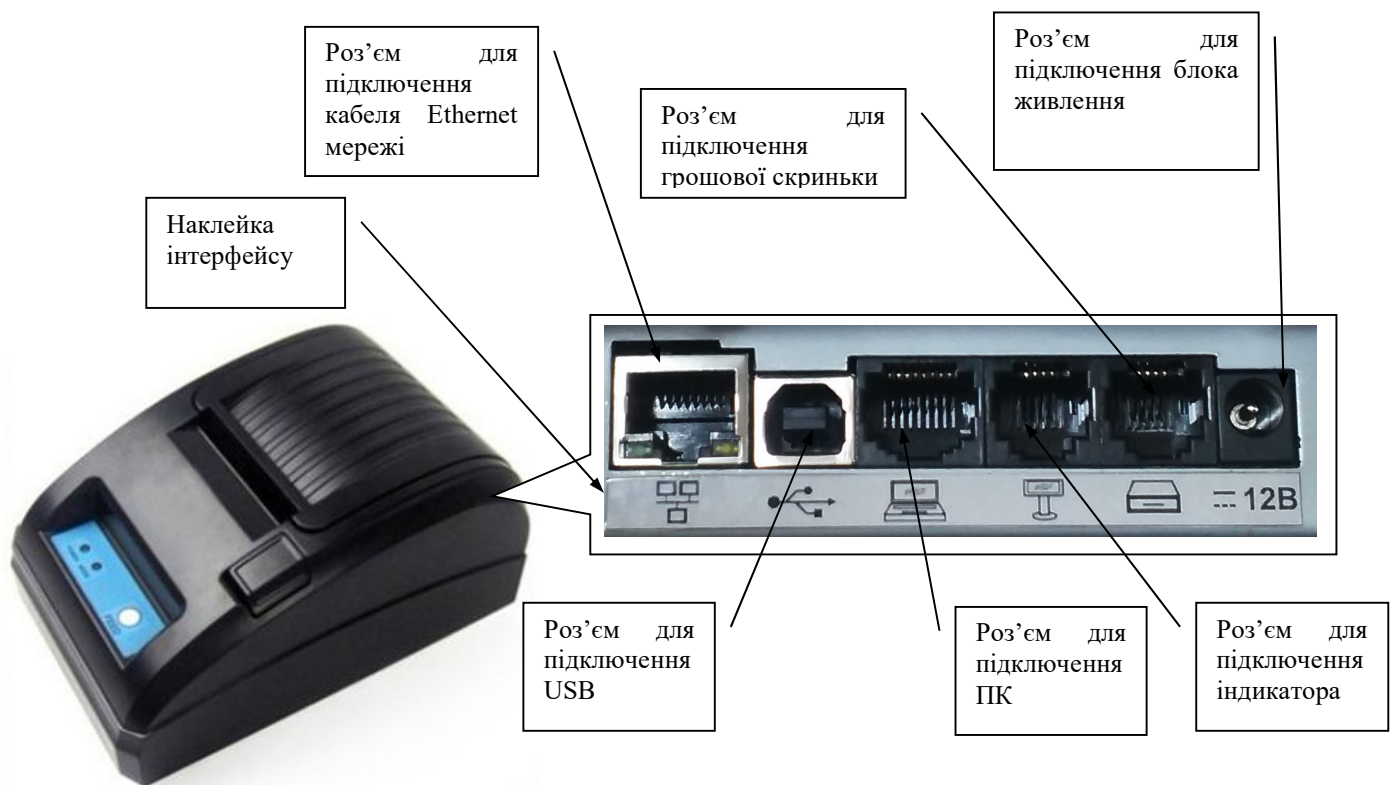
Рисунок 3 – Роз'єми для підключення зовнішніх пристроїв
